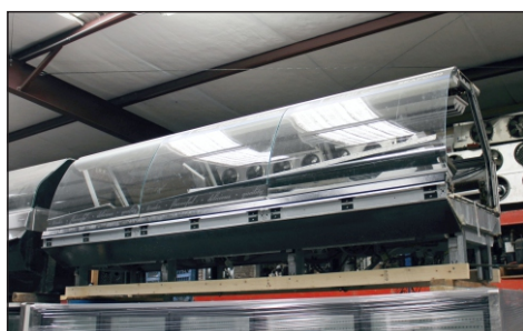
Vitrinas de carne Refrigeración por gravedad
